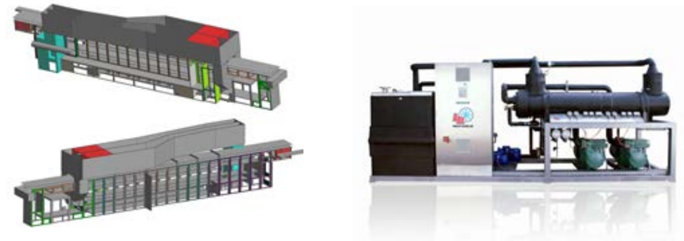
(3) Gute Planung ist die halbe Arbeit: Die Modernisierung der komplexen Kühlstrecken in der Schokoladenproduktion erfolgt mit CAD-Unterstützung. (4) Typische Kälteanlage für die Kühlstrecke in der Schokoladenindustrie.
