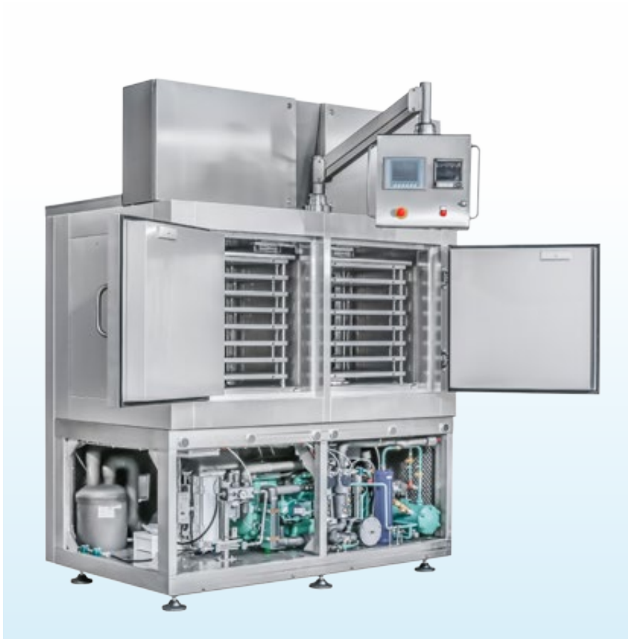
Die Kältetechnik ist in die Anlage integriert.
