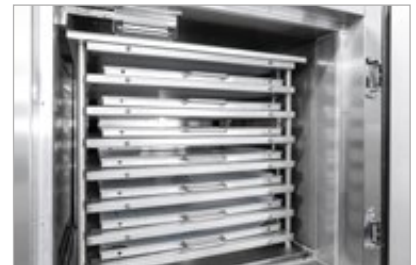
Die Beutel mit Blutplasma werden zwischen die Kontaktplatten eingelegt, die zusammenfahren und eine schnelle Kälteübertragung gewährleisten.
